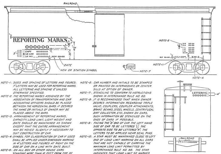
IDTE-5: ON ALL BOX OR DTHER HOUSE CARS STANDING MORE THAN IZ FEET FROM TOP OF 'RAIL TO EAVES, THE HEIGHT AND WIDTH AT EAVES TO BE STENGLED AS SHOWN. WHERE LATITUDINAL RUNNING BOARD IS FLUSH WITH EAVES, THE HEIGHT SHOULD BE GIVEN TO TOP 'OF LATITUDINAL RUNNING BOARD.
